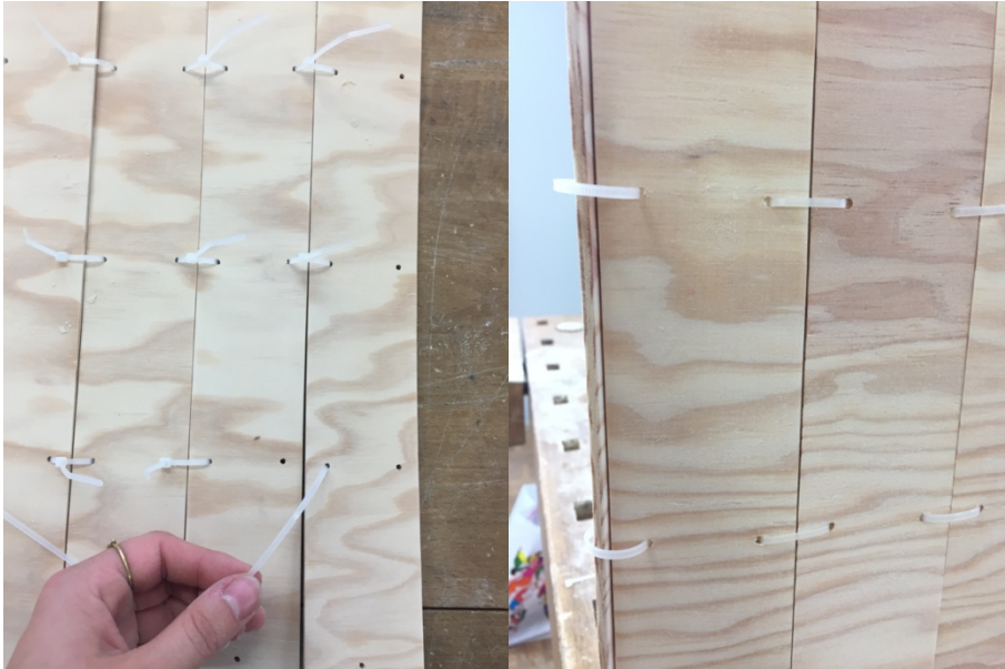
Abbildung 15, 16: Einfügen der Kabelbinder
