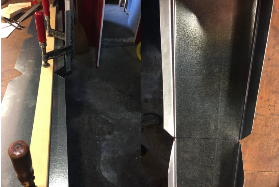
Abbildung 27: Vorbereitung für das Biegen Abbildung 28: gebogenes Metallstück
