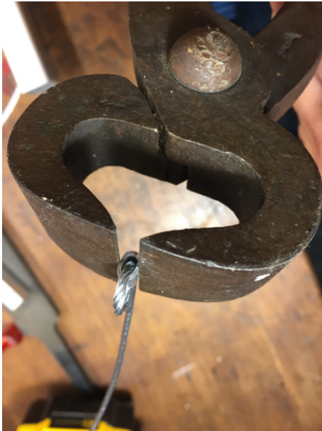
Abbildung 29: Schliessen der Quetschhülse
